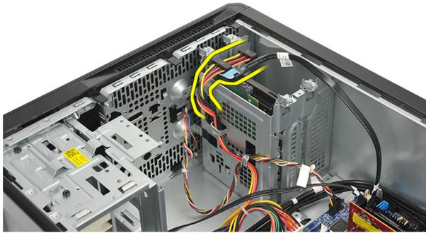
4. Entfernen Sie die Schrauben, mit denen das Festplattenlaufwerk am Computer befestigt ist.
