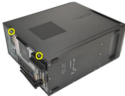
3. Schieben Sie die Computerabdeckung in Richtung der Rückseite des Computers.
