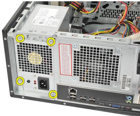
5. Drücken Sie die Entriegelungstaste am Boden des Systemgehäuses und schieben Sie das Netzteil zur Vorderseite des Computers.
