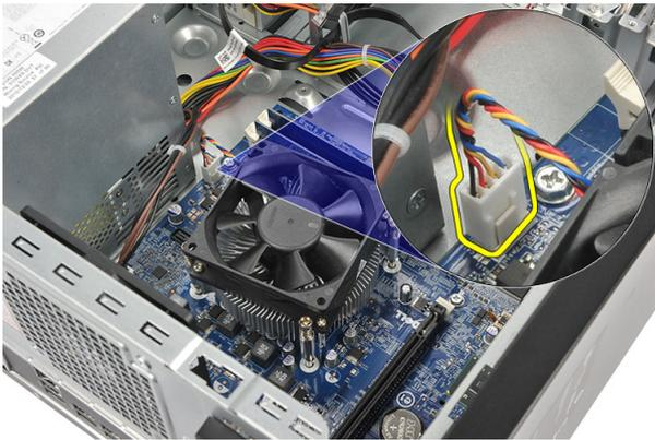
4. Lösen Sie die unverlierbaren Schrauben, mit denen die Kühlkörper- und Lüfterbaugruppe an der Systemplatine befestigt ist.
