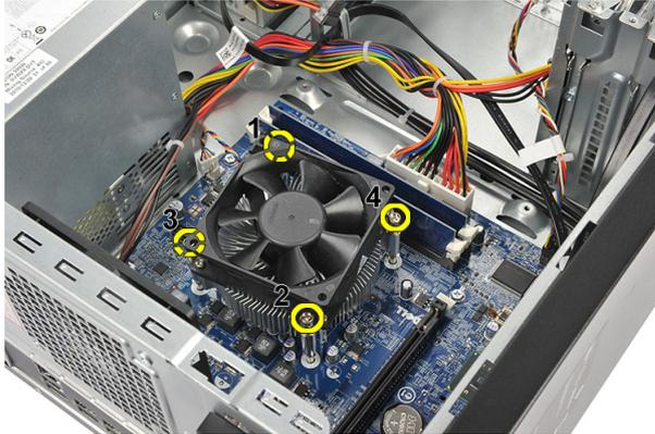
5. Heben Sie die Kühlkörper- und Lüfterbaugruppe an und entfernen Sie sie aus dem Computer.
