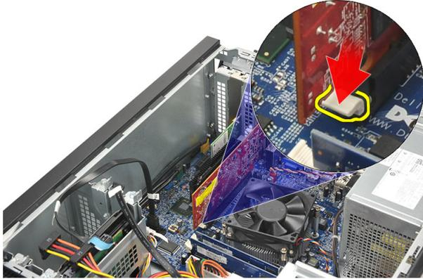
5. Heben Sie die Karte aus ihrem Anschluss und entfernen Sie sie aus dem Computer.
