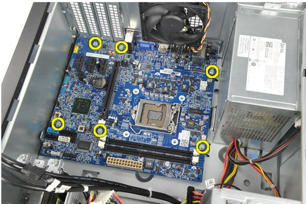
5. Schieben Sie die Systemplatine zur Vorderseite des Computers und bringen Sie sie vorsichtig in einen 45-Grad-Winkel.
