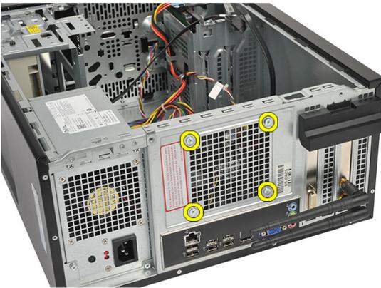
5. Entfernen Sie den Lüfter aus dem Computer.
