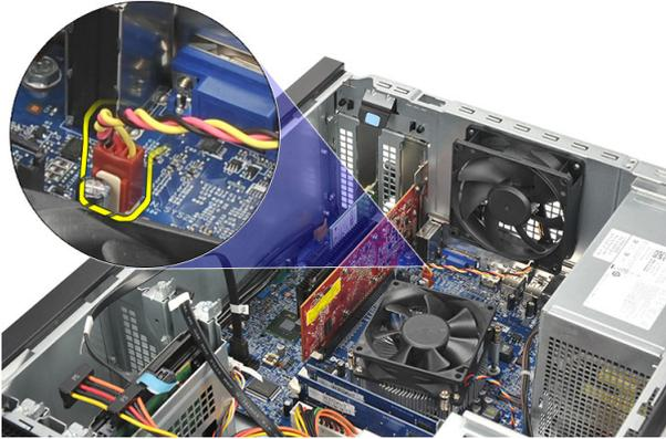
4. Entfernen Sie die Schrauben, mit denen der Lüfter an der Computerrückseite befestigt ist.
