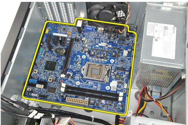
6. Entfernen Sie die Systemplatine vorsichtig aus dem Computergehäuse und bewahren Sie sie in einer antistatischen Schutzhülle auf.
